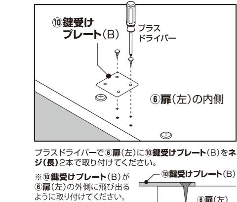
※⑩鍵受けプレート(B)が⑥扉(左)の外側に飛び出るよう取り付けてください。
