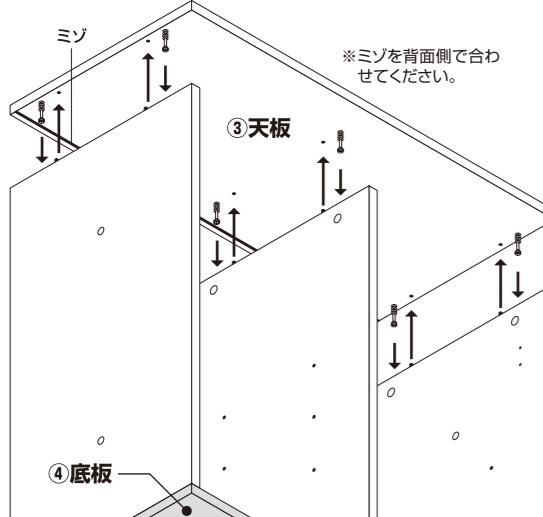
6 本体背面に⑰背板止めの羽部分を⑦背板とミゾの間に差し込み、プラスドライバーでネジを締めて取り付けてください(下図の10ヶ所)。
