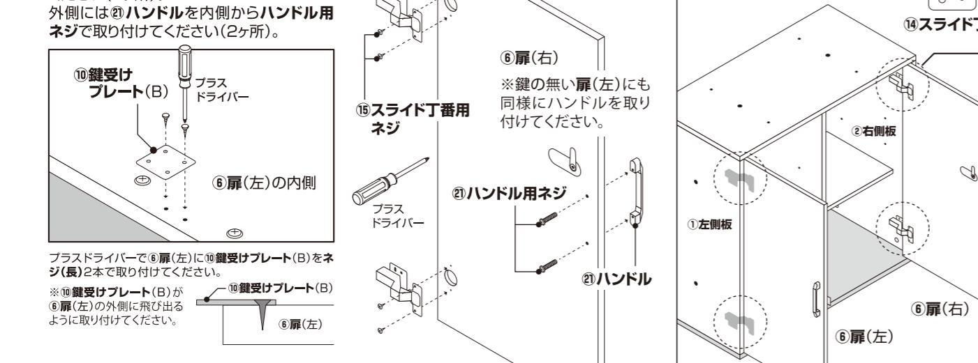
[1] ①左側板・②右側板の穴に穴Aを合わせ、⑯スライド丁番用ネジで取り付けてください。扉の高さを調整し位置を決めたらネジを締めます。
