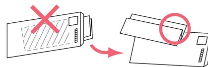
注5> 透明封筒や窓付封筒(フィルム)、宛名ラベル(粘着剤つき)の貼ってある封筒を細断しないでください。
