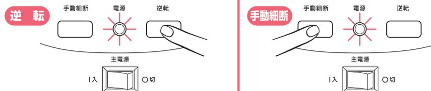
1. 細断を途中で中止したり、詰まった用紙が取り出せない時に「逆転」スイッチを押してください。スイッチを押している間は、刃が逆回転します。
