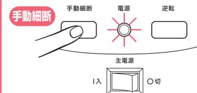
1. 主電源スイッチが「入」の時にこのスイッチを押している間は強制的に刃が正回転します。
