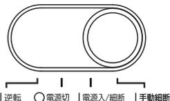
⑦ 電源スイッチを「**電源入/細断**」にして細断枚数を減らし、細断していない方向から、再度細断してください。
