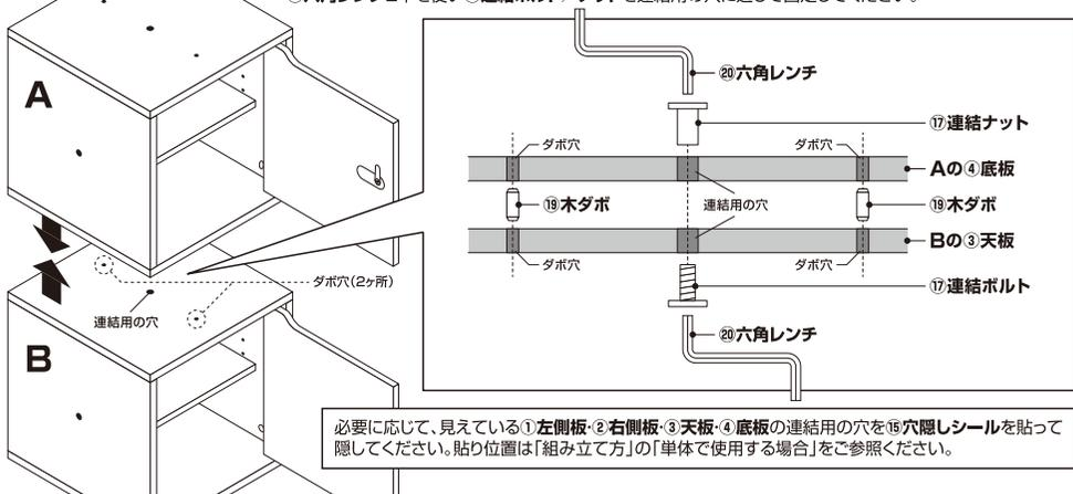
必要に応じて、見えている①左側板・②右側板・③天板・④底板の連結用の穴を⑱穴隠しシールを貼って隠してください。貼り位置は「組み立て方」の「単体で使用する場合」をご参照ください。
