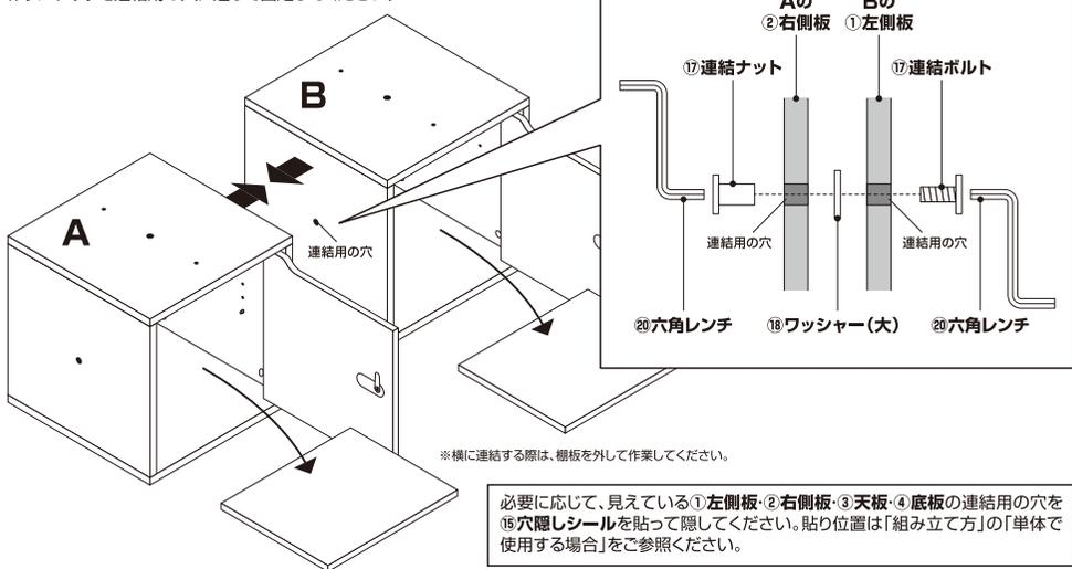
必要に応じて、見えている①左側板・②右側板・③天板・④底板の連結用の穴を⑱穴隠しシールを貼って隠してください。貼り位置は「組み立て方」の「単体で使用する場合」をご参照ください。
