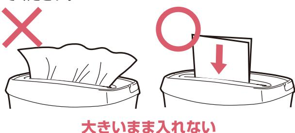
●通常の細断・続けて細断する時は定格細断枚数以上を入れないでください。
