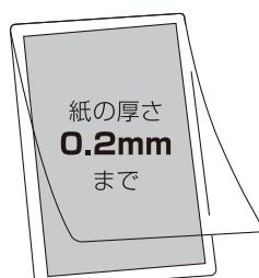
●フィルムの厚さを含む一度にラミネートできる最大の厚さ(最大ラミネート厚)は0.5mmです。
